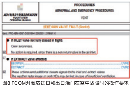
图8 FCOM对蒙皮进口和出口活门在空中故障时的操作要求
