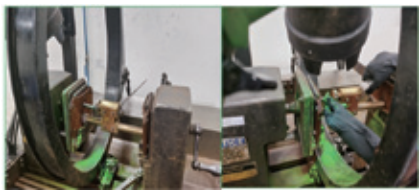
图6 夹在电极和夹片间的螺栓
